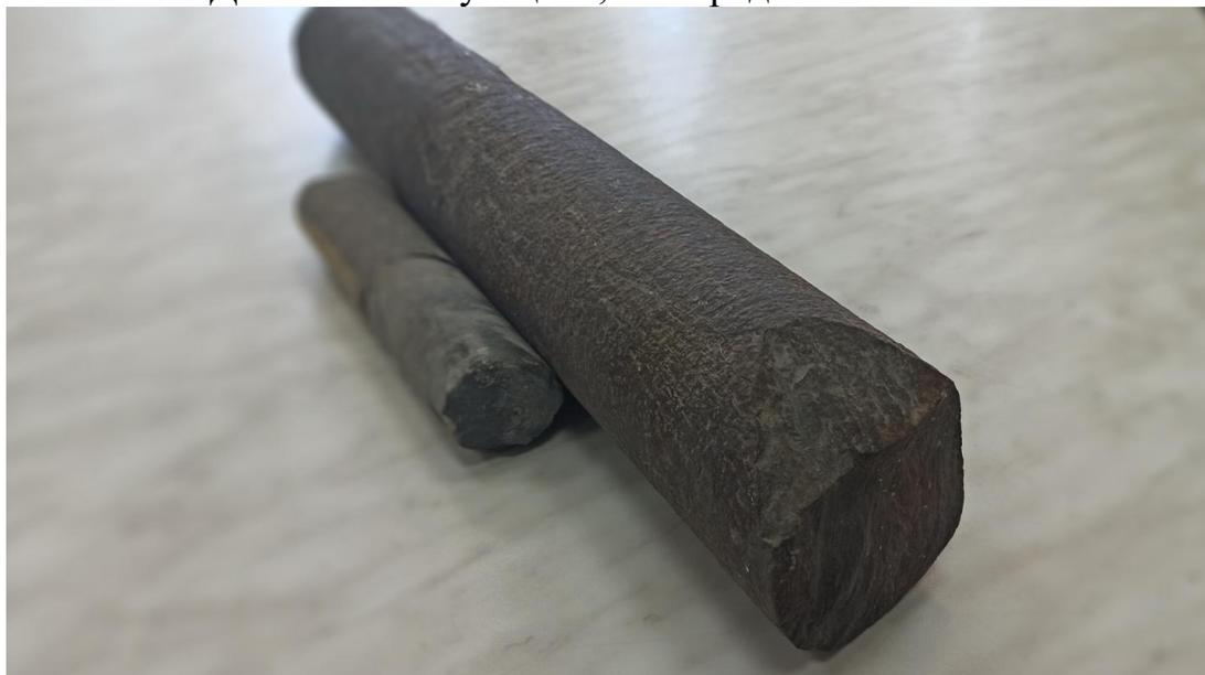
*Рис. 2 Керн железистого кварцита (Фото Гонеев И.А.)*
